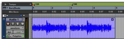
Tempo conformed audio, linear tempo change
